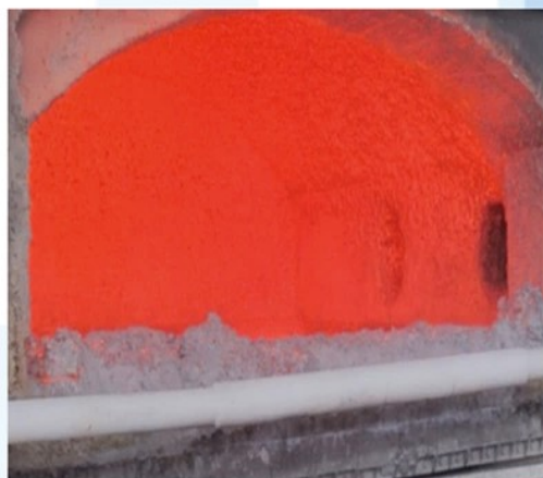
使用中的BA不粘铝浇注料 BA Non-stick aluminium castable in use
