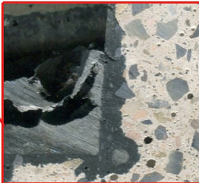
铝液与耐火材料的反应 Reaction of liquid aluminum and refractory
