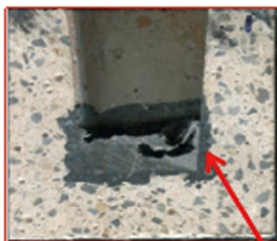
铝液与耐火材料的反应 Reaction of liquid aluminum and refractory
